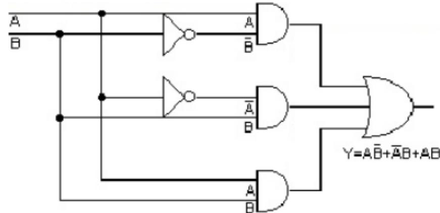
Observar que deben utilizarse seis compuertas para implementar este circuito lógico, que realiza la lógica detallada en la tabla de verdad que se muestra.
